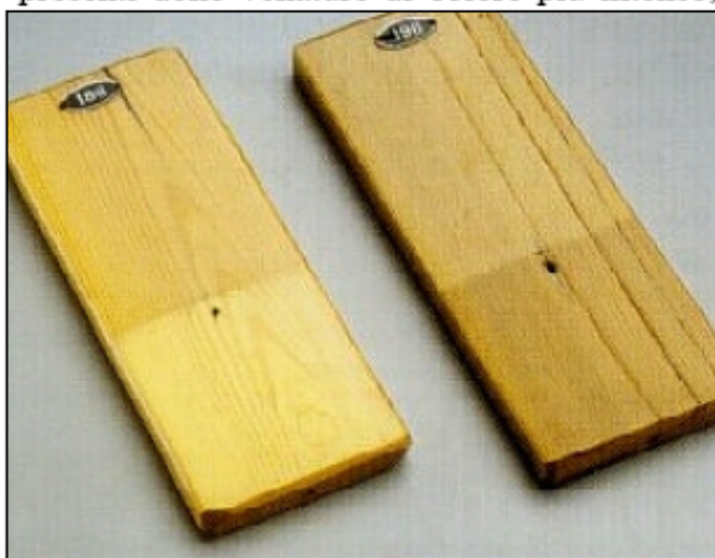
Foto 2: Variazione del colore del legno in funzione della specie legnosa. Da sinistra: Pino e Rovere. Solo la parte superiore è stata esposta alla luce solare.
